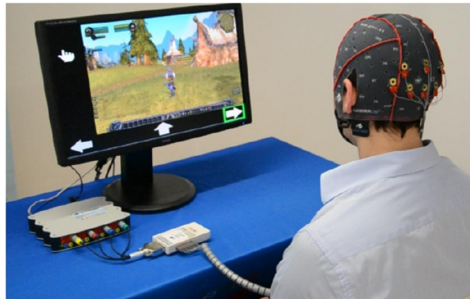
Figura 5.4: Ejemplo de uso de un sistema BCI para controlar la acción durante la ejecución del videojuego Warcarft
